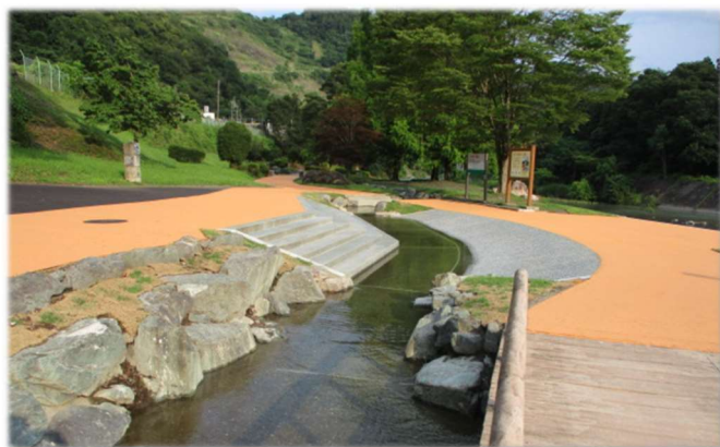
（写真）神流川水辺公園：水遊びができるよう、安心してせせらぎに入れるようになりました。オレンジ色の部分は遮熱舗装となっており、舗装面が高温にならないような対策が施されています。
